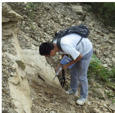
图4 野外基岩露头针贯入原位测试
