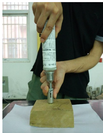
图5 针贯入室内试验
